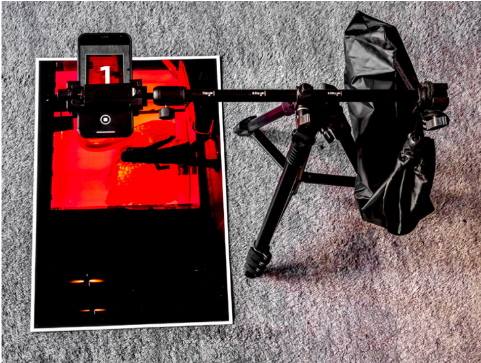
Abb. 6: Abfotografieren eines großformatigen analogen Fotoabzugs mit dem Smartphone – der Selbstauslöser ist aktiviert. Das gezeigte Stativ (ab ca. 35 Euro erhältlich, auch geeignet für klassische Digitalkameras) verfügt über eine Querstange, die es ermöglicht, das Motiv senkrecht von oben komplett zu erfassen (der gefüllte Beutel rechts dient als Gegengewicht, damit das Ganze nicht umkippt!).
