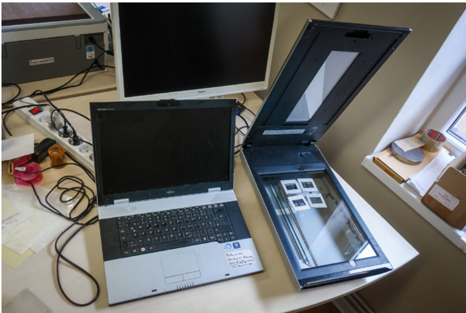
Abb. 5: Ein Flachbettscanner mit angeschlossenem Laptop. Gut zu erkennen auf dem Foto ist die zusätzliche Beleuchtungseinheit des Flachbettscanners im Deckel, also oberhalb des Auflageglases. Damit kann man Negative und Dias „durchleuchten“ (zum Scannen von Dias und Negativen siehe unten Seite 14).
