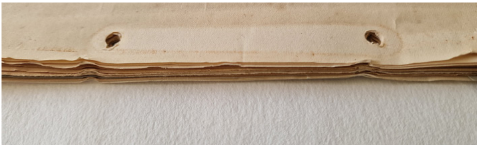
Abb. 1: Der Bügel eines Ordners hat sich während der Einlagerung in die abgehefteten Schriftstücke gedrückt.
